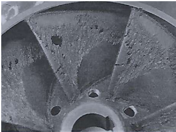
Voorbeeld van cavitatie bij schroefwaaier
