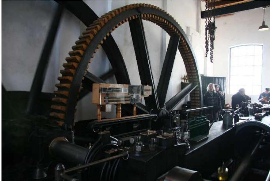
Voorbeeld van tandwiel met houten tanden (Gemaal Hertog Reijnout)
